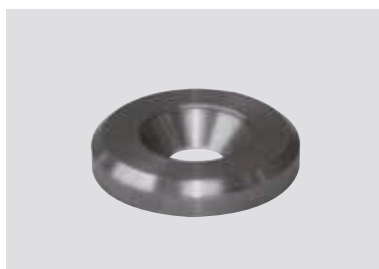
TA-020 • Nerūdijančio plieno taškinis laikiklis su juoda nailono tarpine, Ø 30 mm x H 6 mm, varžtui su įleidžiama galvute M8, skylė stiklė 15 mm. • Point holder in stainless steel with gasket, Ø 30 mm x H 6 mm, for screw M8, glass hole 15 mm.
